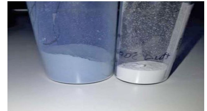
Lanthan-Strontium-Manganese oxide – nanoparticles : La 0,7 Sr 0,3 MnO 3
